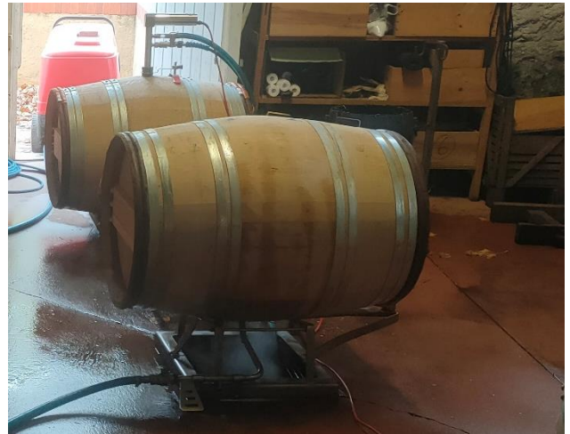
Figure 21 : Dispositif de rinçage des barriques
