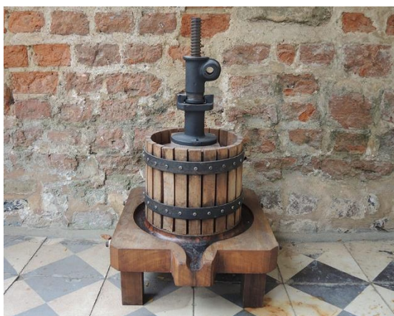
Figure 25 : Petit presseoir utilisé pour presser les échantillons des contrôles maturités
