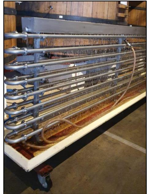
Figure 20 : Photographie d'un échangeur tubulaire. Image personnelle.
