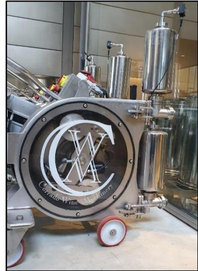
Figure 10 : Photographie des pompes utilisées au chai. Image personnelle.
