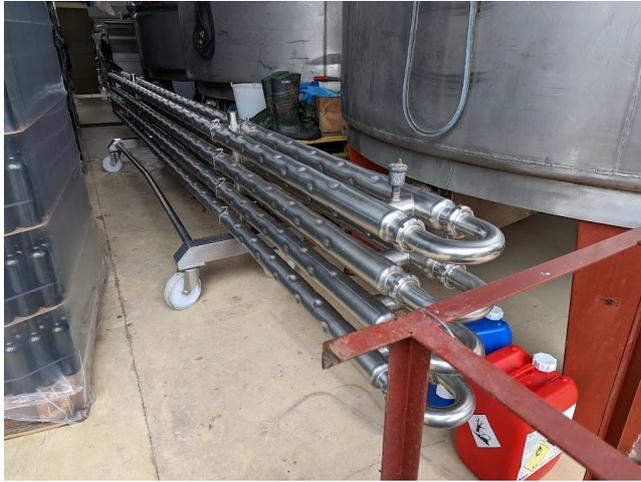
*Figure 9 : Echangeur tubulaire (source : personnelle)*
