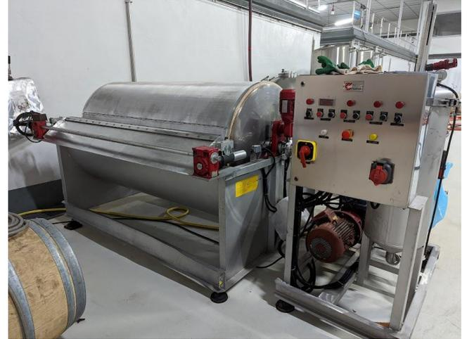
*Figure 12 : Filtre rotatif sous vide (source :
