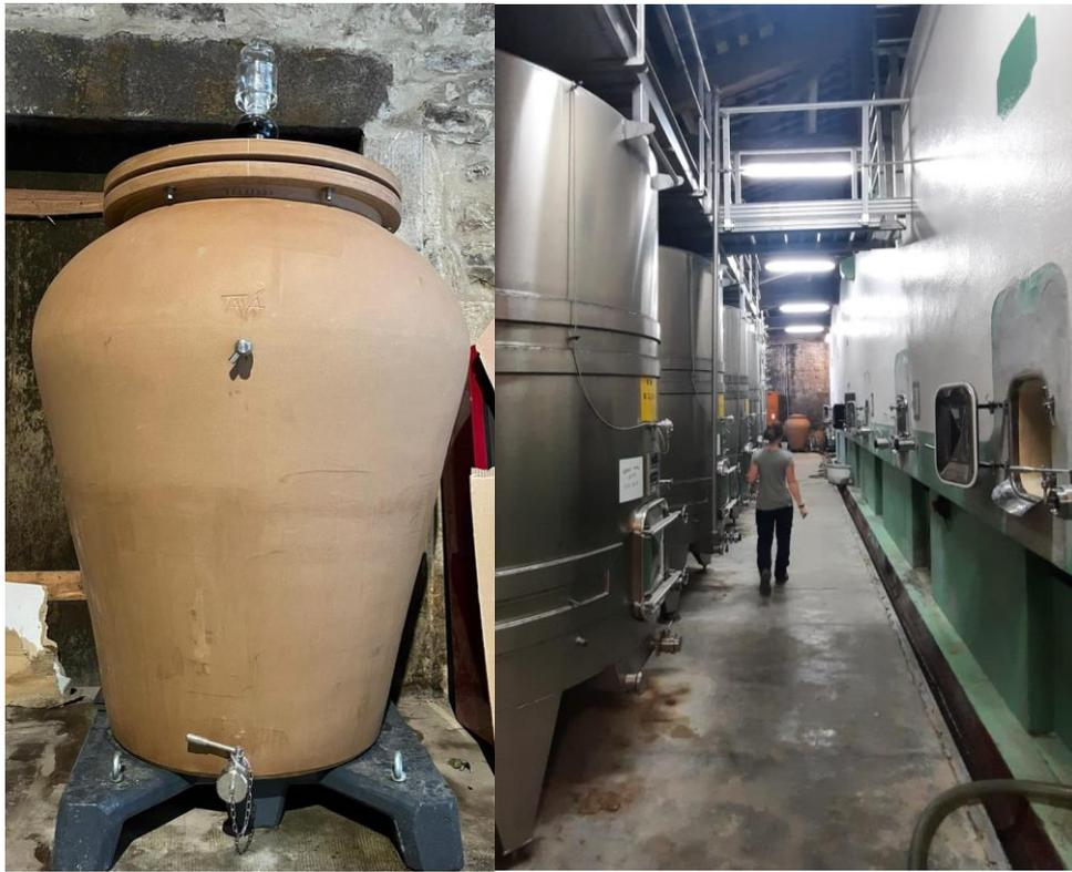
Figure 23 Photo d'une amphore, des cuves en béton et des cuves en inox (source personnel)
