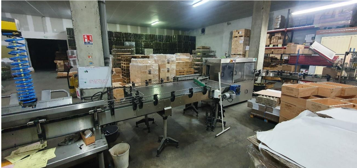
Figure 37 : Bouteiller - de gauche à droite - ventouse/table d'accumulation/laveuse sécheuse
