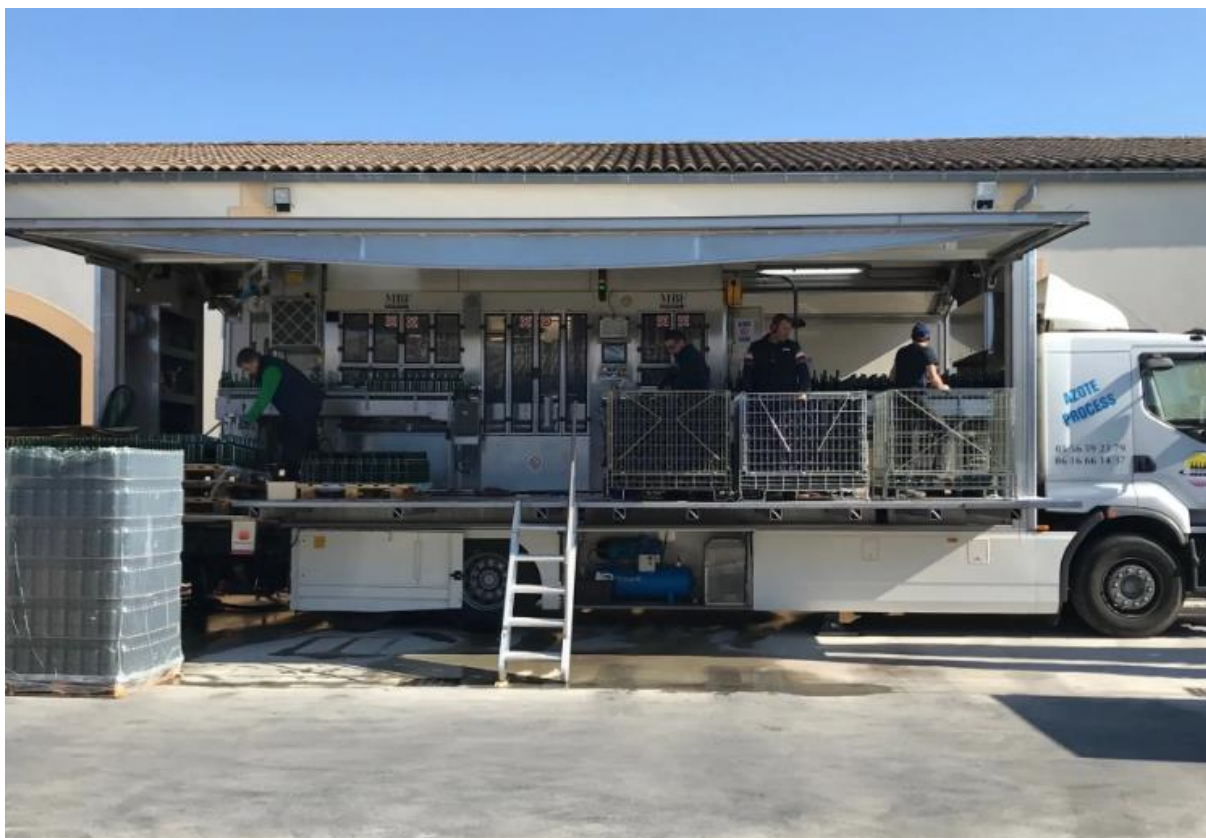
Figure 36 : Chaîne de mise en bouteille du prestataire AROMA 2000 (source www.aromaembouteillage.fr 5 )
