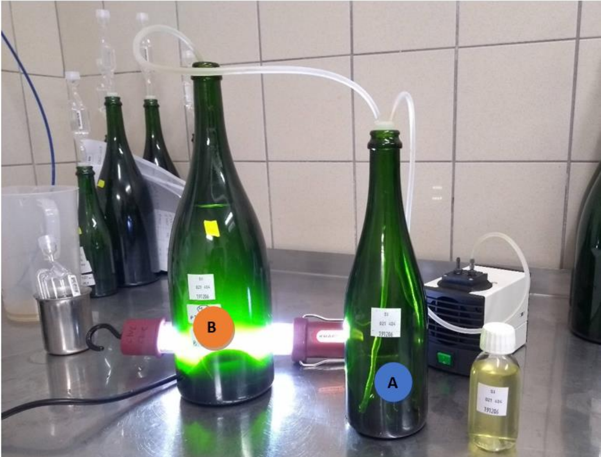
Figure 38 : Réalisation du soutirage des micro-vinifications à l'aide d'une petite pompe permettant de transvaser le jus clair sans lies de la bouteille B vers la bouteille A qui deviendra alors le nouveau contenant.
