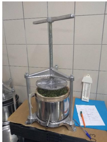
Figure 33 : Pressoir à vis manuel permettant de presser des vendanges de moins de 3 kg. Utilisé au Comité Champagne pour les essais de variétés résistantes en sélection intermédiaire
