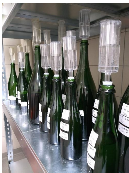
Figure 34 : Contenants pour la FA surmontés de bondes remplies d'eau empêchant l'entrée d'O 2 tout en laissant le CO 2 s'évacuer
