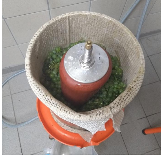
Figure 18 : Pressoir pneumatique manuel en cours de remplissage pour effectuer le pressurage d'une variété résistante en sélection intermédiaire. Ce type de pressoir est utilisé pour les récoltes supérieures à 3 kg
