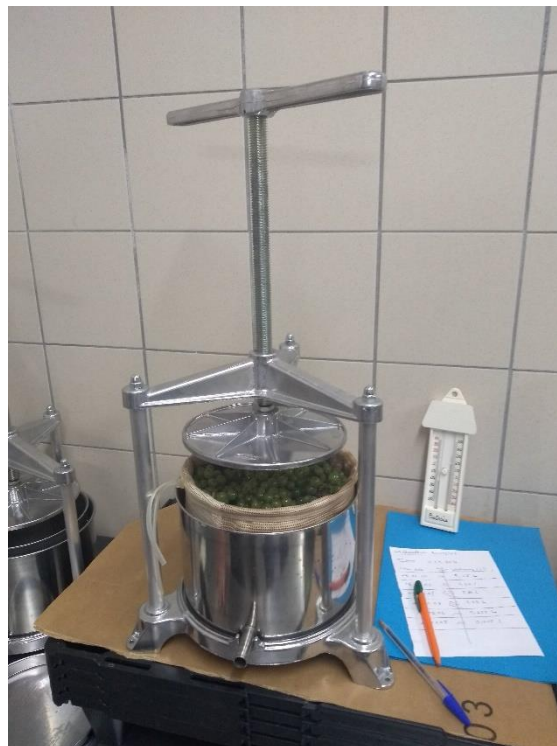
Figure 19 : Pressoir manuel à vis, en cours de de remplissage pour effectuer le pressurage d'une variété résistante en sélection intermédiaire. Ce type de pressoir est utilisé pour les récoltes inférieures à 3kg
