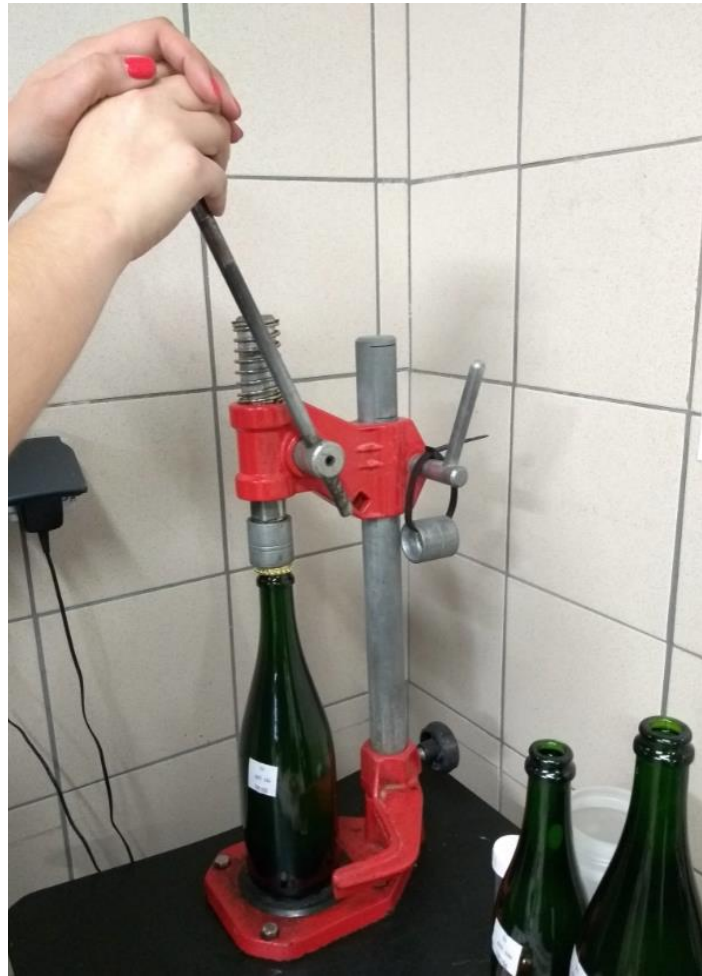
Figure 39 : Opération de capsulage des bouteilles issues de la micro-vinification des Sélections Intermédiaires après sulfitage
