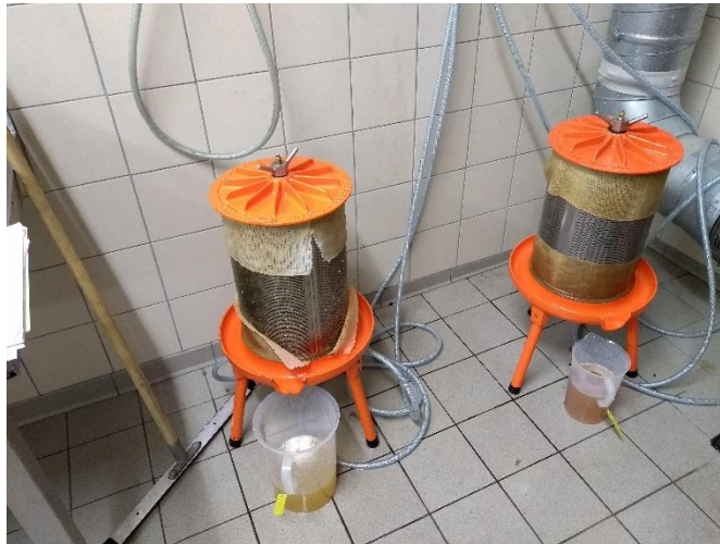
Figure 32 : Pressoirs pneumatiques manuels utilisés pour le pressurage des vendanges de plus de 3 kg des essais portant sur les variétés résistantes en sélection intermédiaires. Ils disposent d'un suivi de pression
