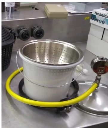
Figure 21 : Parapress de 2,5 L utilisé afin d'extraire le jus des bails pour réaliser le suivi maturité
