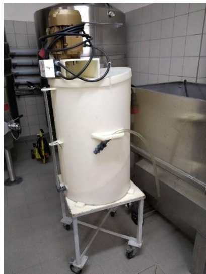
Figure 44 : cuve servant à faire fondre le sucre saccharose pour la préparation de la mixtion, munie d'un système de remuage (hélice et moteur)
