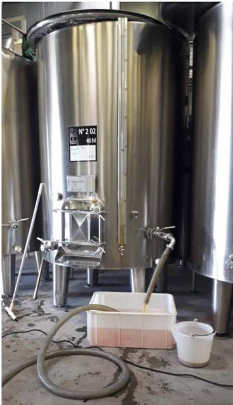
Cette étape vient après le débouillage et permet de séparer la phase solide de la phase liquide. Le jus clair est soutiré avec aération et envoyé dans une autre cuve. Pour ce faire, le moût est écoulé dans un récipient puis il est pompé, de ce bac, jusqu'à une autre cuve de stockage. Le moût écoulé passe par un mireur, permettant de piloter correctement cette opération (*Figure 16*).
