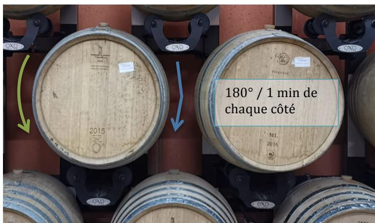
**Image 31 : Disposition des barriques dans le chai des blancs sur Oxo facilite les opérations de bâtonnage**
