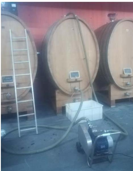
**Image 19 : Opération de détoxification d'un foudre lors d'un arrêt de fermentation**
