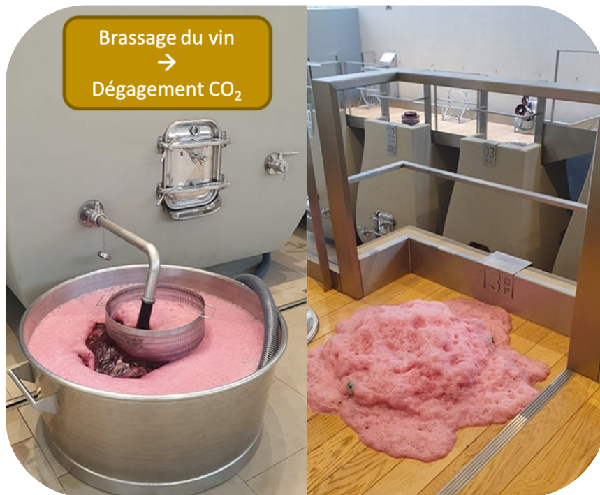
Figure 25 : Débordement d'une cuve
