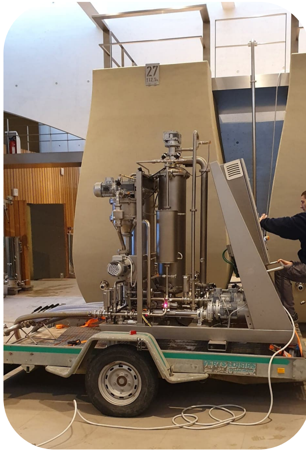
Figure 42 : Filtration tangentielle d'une barrique comportant une population de Brettanomyces
