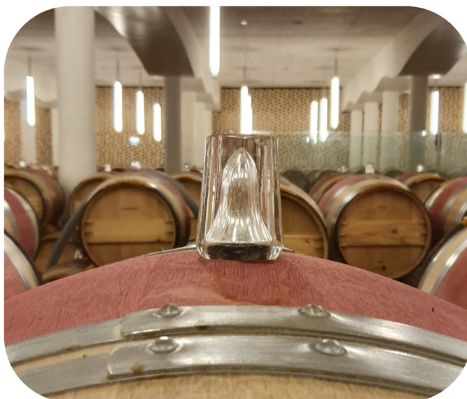
Figure 40 : Utilisation de bondes en verre après l'entonnage pour permettre un dégazage
