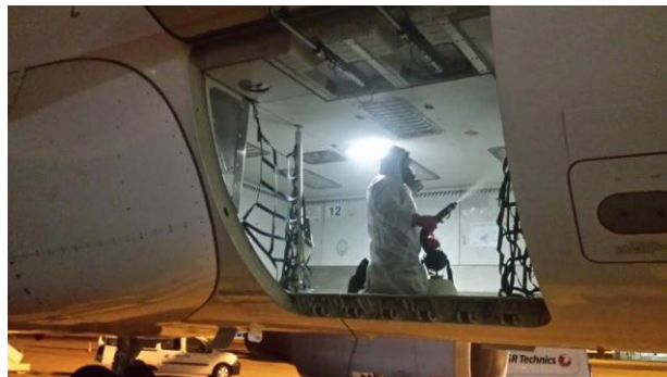
Figure 74 : Désinsectisation d'un avion à l'aide d'un insecticide rémanent (531)
