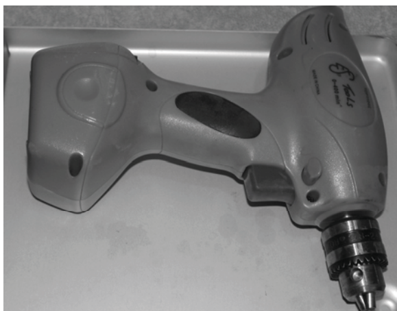
Figure 29 : Perceuse basse vitesse utilisable en orthopédie des oiseaux (Photo A. Mercier).
