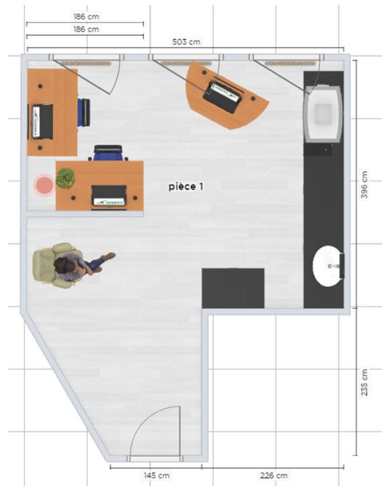
Figure 99 : Plan 2D et représentation 3D du laboratoire 3D du service de chirurgie maxillo-faciale du CHU de Nantes : aménagement en deux parties distinctes avec espace dédié à l'accueil du patient et second espace pour le traitement 3D.
