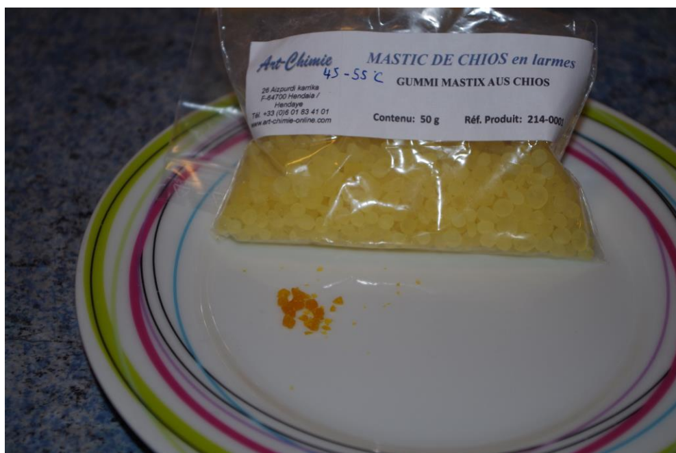
Fig. 22. Comparaison de la résine de Mastic de Chios d'origine (sachet, couleur jaune clair) avec la résine non dissoute après les deux heures de cuisson au bain-marie (dépôt dans l'assiette, couleur orange).
