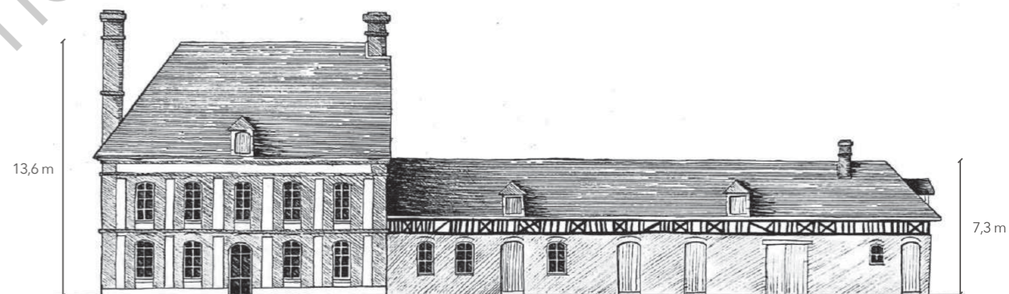
Élévation Sud-Est : à gauche la partie récente en brique et enduit ; à droite la partie ancienne en grès, silex, briques et pans de bois 1
