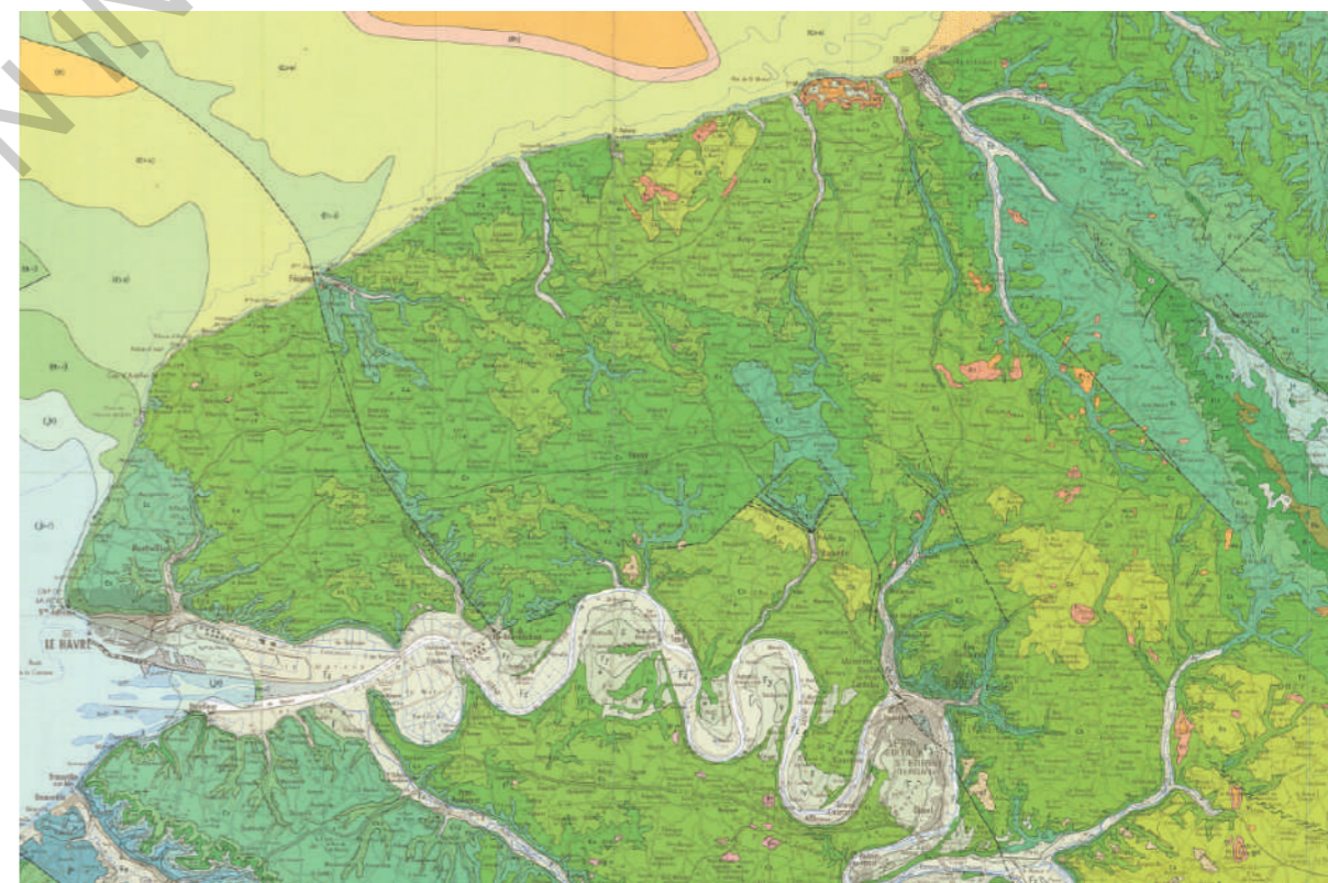
La carte géologique, qui illustre l'homogénéité de la composition des sols, calcaires, du pays de Caux. 1 (En vert : craie blanche / en vert-bleu : craie grise / en bleu : calcaires et argiles / en blanc : alluvions)
