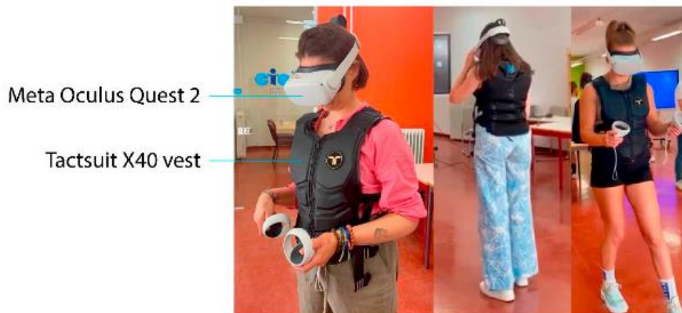
Figure 8 : gilet haptique porté par une utilisatrice, avec un visiocasque Oculus® et des contrôleurs aux deux mains. (23)
