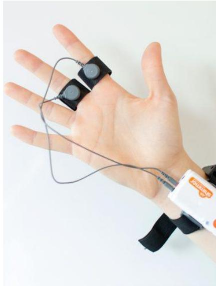
**Figure 24 : Capteurs digitaux pour la mesure de l'activité électrodermale (128)**
