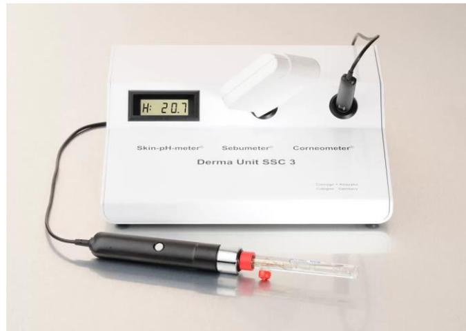
**Figure 11 : Le cornéomètre pour la mesure du taux d'hydratation (86)**
