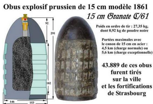
Figure 20 : Image explicative sur l'obus utilisé par l'armée prussienne au cours de la guerre de 1870
