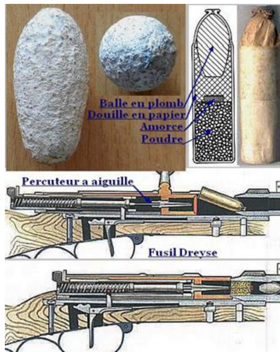
Figure 18 : Représentation du fonctionnement du fusil Dreyse et des balles utilisées
