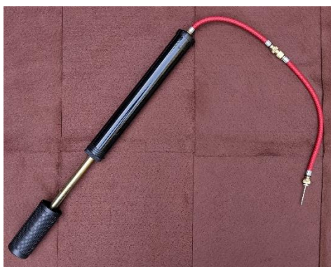
Figure 5 : Pompe à ballon permettant de simuler la dilatation de l'estomac (cliché N. DESFORGES)
