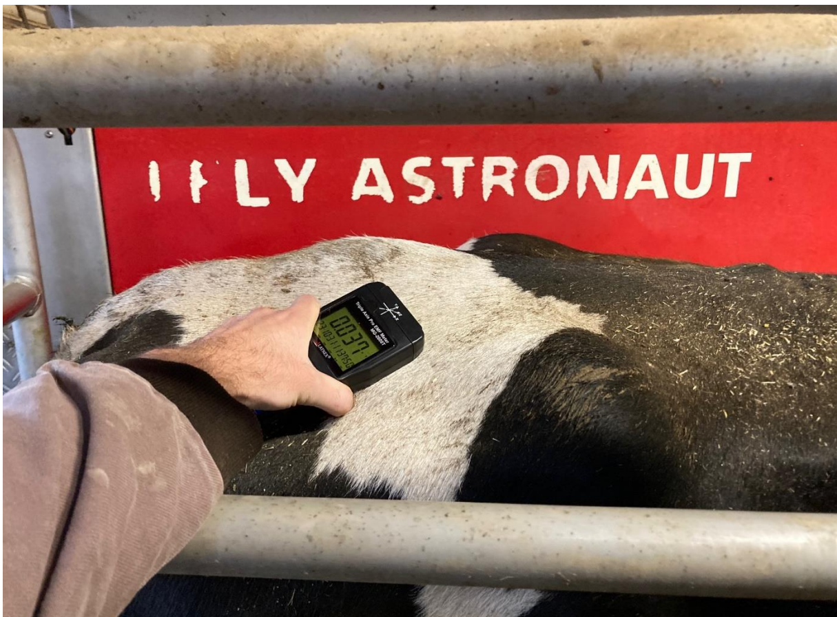
Figure 5 : Méthode de mesure du champ magnétique dans le robot
