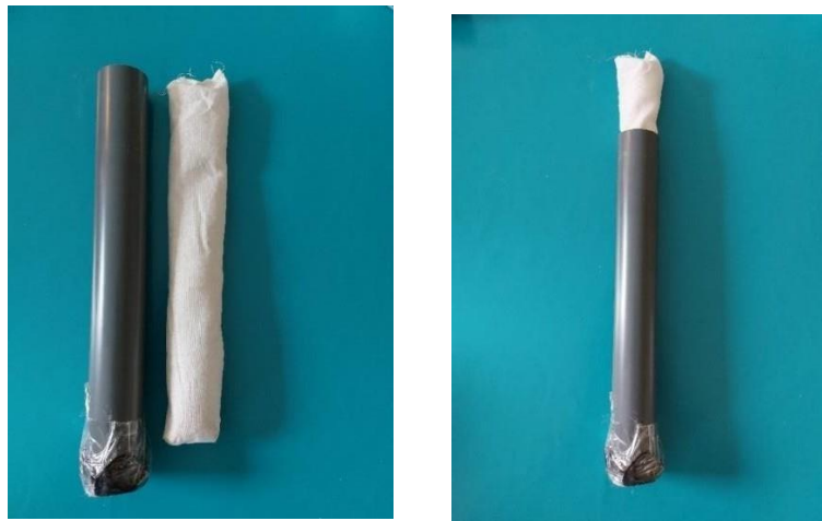
Fig. 44: Photographies des pattes en PVC avec leur poids à l'intérieur. Source personnelle
