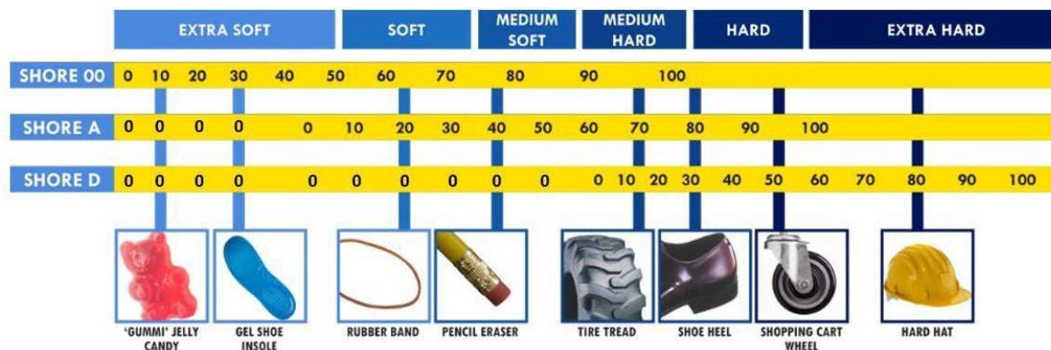
Fig. 23: Schéma des shore 00, A et D ainsi que leurs équivalences. Source site Smooth-on
