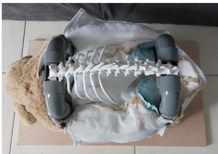
Fig. 52: Photographies du mannequins Scraps avec sa peau, son squelette, sa rate et son socle. Source personnelle
