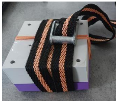
Fig. 26: Photographie du premier moule imprimé en PBS à taille réduite par rapport au mannequin et du coulage de silicone. Source personnelle
