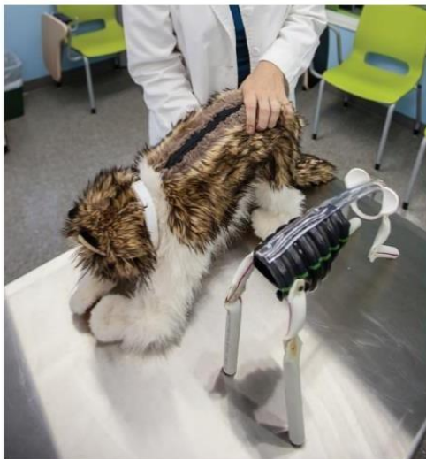
Fig. 10: Photographie du mannequin d'abdomen de chat (à gauche) et son squelette interne (à droite). Source (9)
