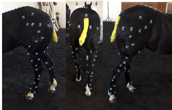
Figure 27 : Emplacement des capteurs sur un cheval durant les mesures de cinématique 3D (Seino, 2019)
