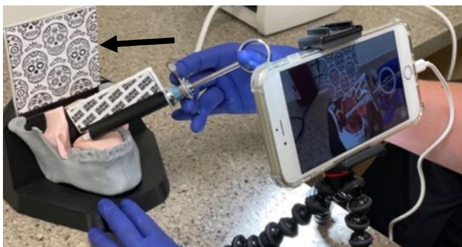
Figure 27 : Un étudiant utilise le simulateur IA. Des cibles d'image (→) sont attachées à la seringue et au modèle pour permettre au dispositif mobile de suivre la seringue physique et de représenter correctement sa position dans la simulation.(43)
