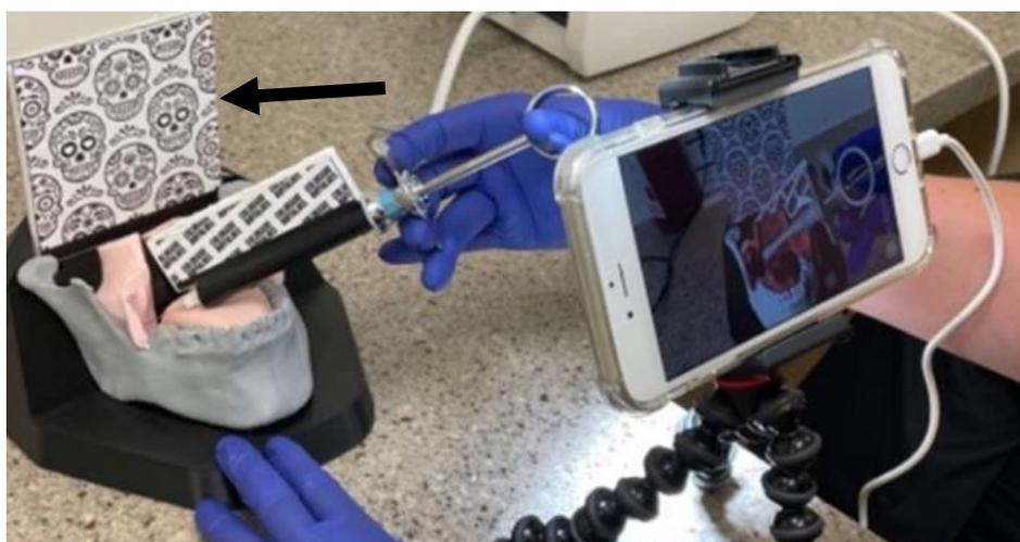
Figure 27 : Un étudiant utilise le simulateur IA. Des cibles d'image (→) sont attachées à la seringue et au modèle pour permettre au dispositif mobile de suivre la seringue physique et de représenter correctement sa position dans la simulation.(43)
