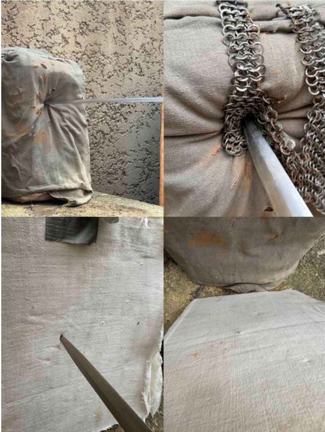
Figure 34: Il suffit de très peu de force pour pénétrer de plus de 10cm l'argile quand celle-ci n'est couverte que par une tunique repliée sur elle-même. Le poids de l'arme étant concentré au niveau de la main, la pointe est trop légère et le métal trop fragile et souple pour forcer le passage lorsqu'elle rencontre de la résistance. La maniabilité de l'arme devient essentielle face à une défense très active ou un adversaire bien protégé, afin de minimiser le risque de l'endommager. Est illustrée ici une comparaison entre les diverses protections – la tunique est aisément enfoncée, le linothorax légèrement percé avec une ouverture visible de l'autre côté, et la cotte de mailles, qui est enfoncée mais ne s'ouvre pas. (Photographies par Brân Dufraisse)
