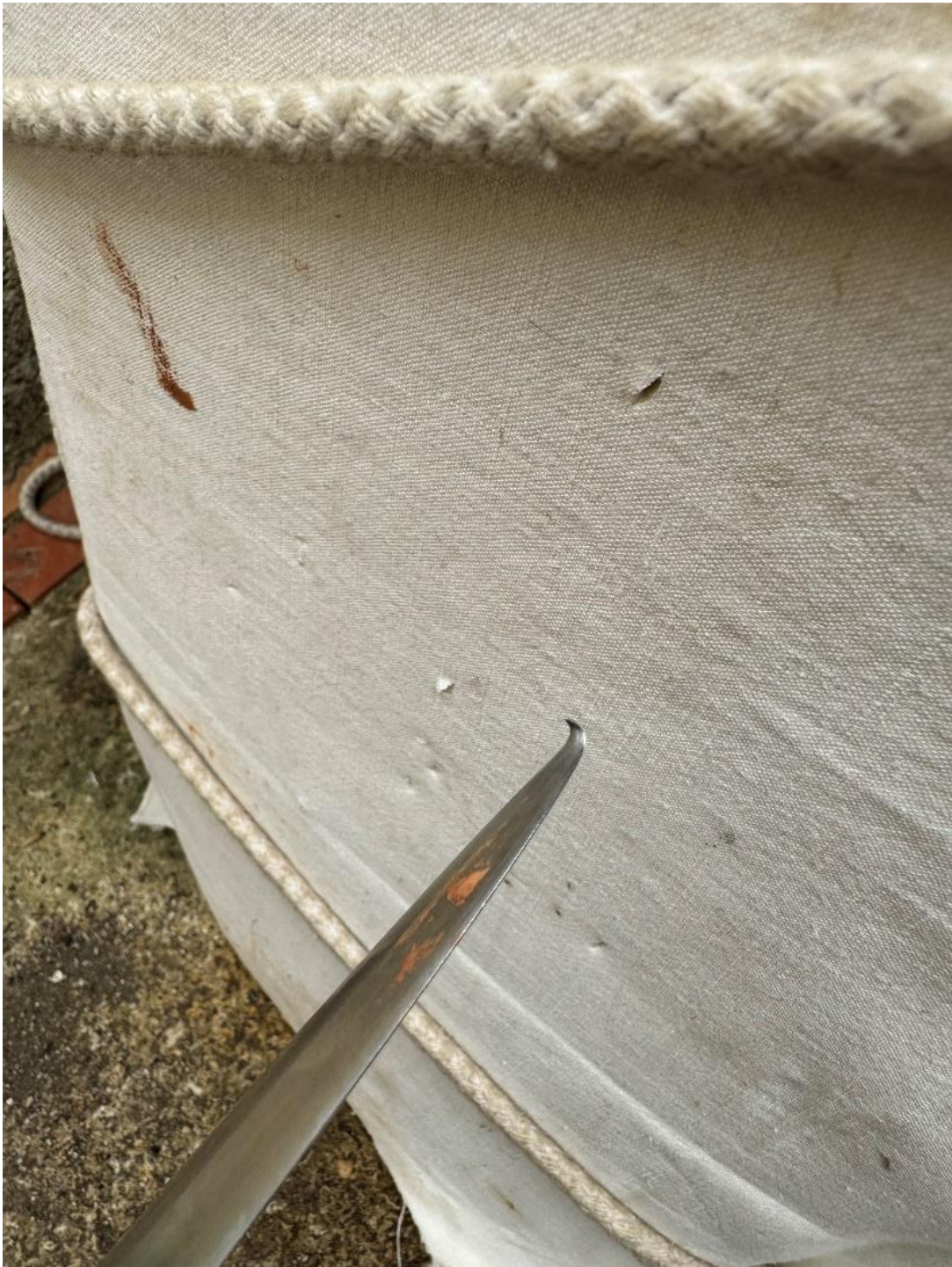
Figure 33: Après plusieurs estocs contre une protection de type-linothorax, la pointe se tord, suggérant ainsi que la morphologie de l'épée à sphères ne la rend pas adaptée à pénétrer des protections, ou à du combat de groupe où les gestes ne peuvent pas être aussi bien maîtrisés qu'en combat individuel ou face à des cibles choisies délibérément. (Photographie par Brân Dufraisse)
