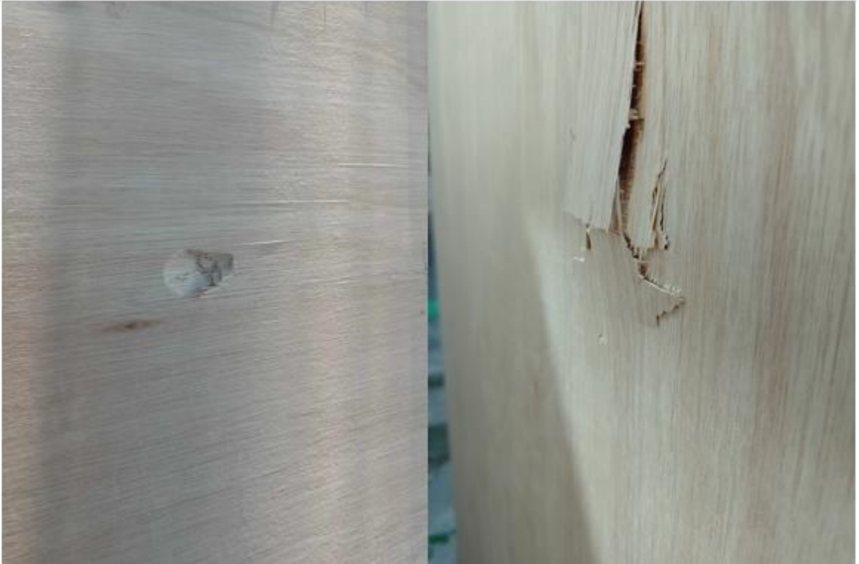
Figure 14: L'impact d'une pierre de 100g tirée à 30m sur une planche de contreplaqué de peuplier de 9mm d'épaisseur. Malgré l'enfoncement considérable, il va de soi qu'un galet plus lisse propulsé par un guerrier de l'époque aurait été encore plus dévastateur. Une telle force de frappe représente un danger considérable. Même si le tir ne mène pas à la mort de la cible, une touche au visage comme a pu vivre Cotta serait très déstabilisante. (Photographie par Thomas Rankin Clergues)
