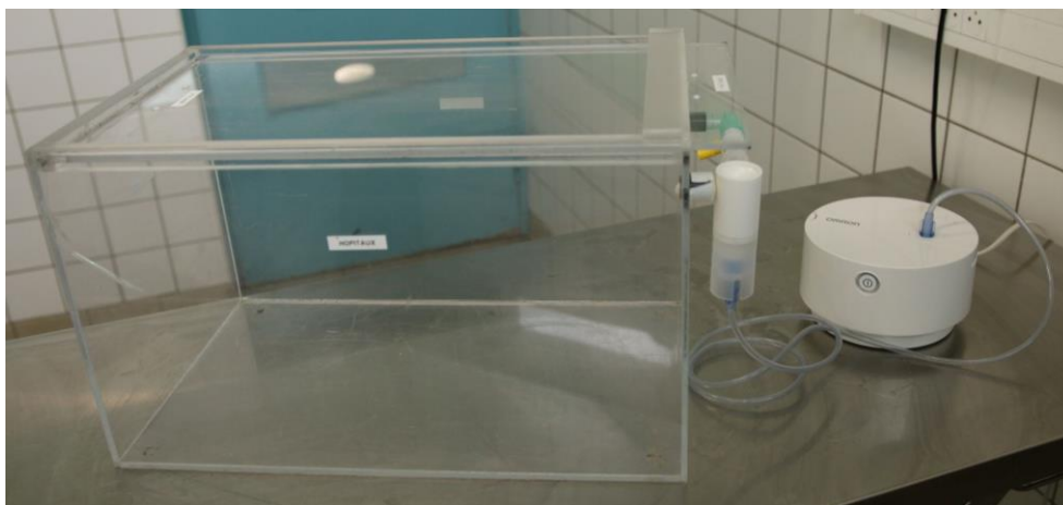
Figure 32 : Photographie d'un dispositif de nébulisation : nébuliseur et caisson étanche (Wagner Camille)
