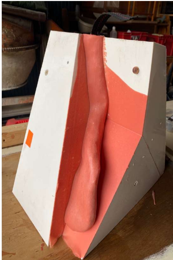
Figure 47 - Utérus 20 Shore après retrait d'une des pièces du moule. Le silicone a coulé entre les pièces, cependant il se détache facilement
