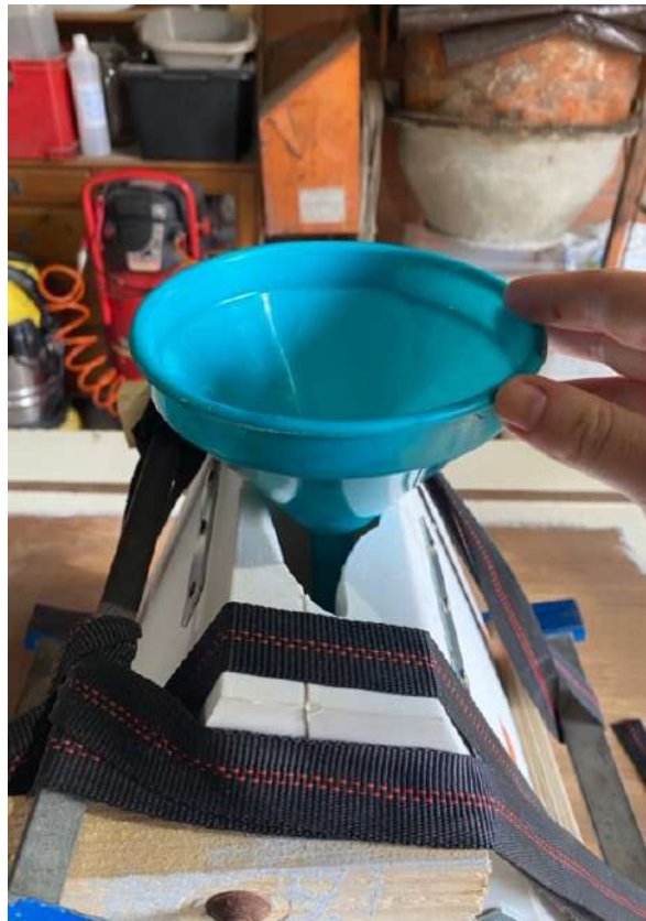
Figure 44 - Première méthode de coulage du silicone à l'aide d'un entonnoir
