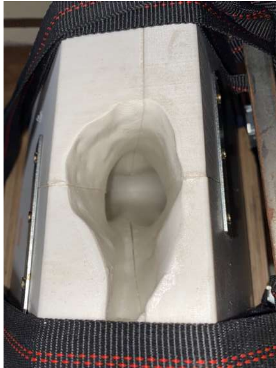
Figure 35 - Vérification de la congruence depuis l'intérieur du moule
