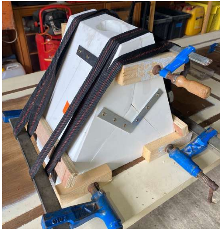
Figure 37 - Mise en place complète du moule lors du premier moulage.
