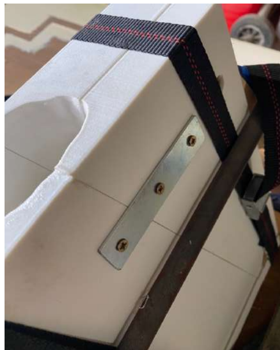
Figure 36- Mise en place d'équerres entre deux pièces du moule
