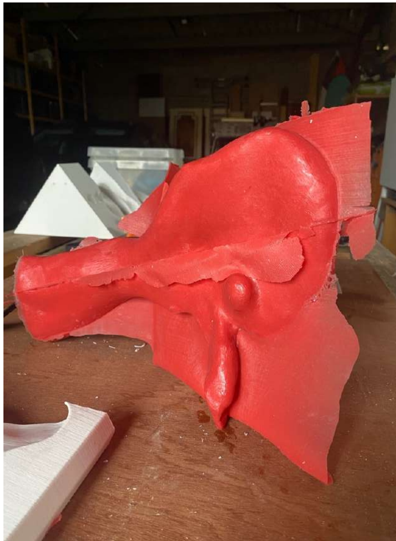
Figure 48 - Utérus en silicone après démoulage direct, le silicone qui avait coulé entre les pièces du moule est visible.
