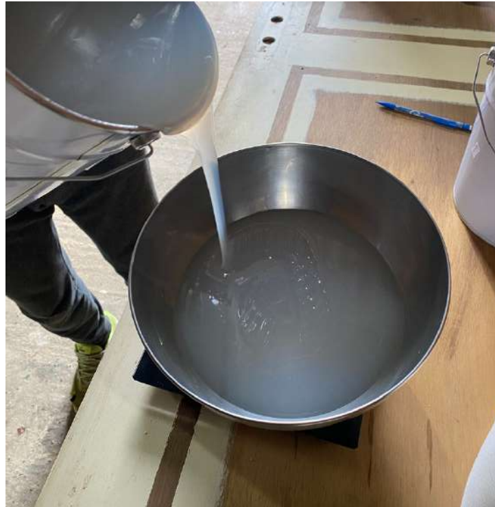
Figure 41 - Versement progressif du catalyseur B dans la base A. Une balance est insérée sous le récipient afin de vérifier le poids au cours de l'opération.
