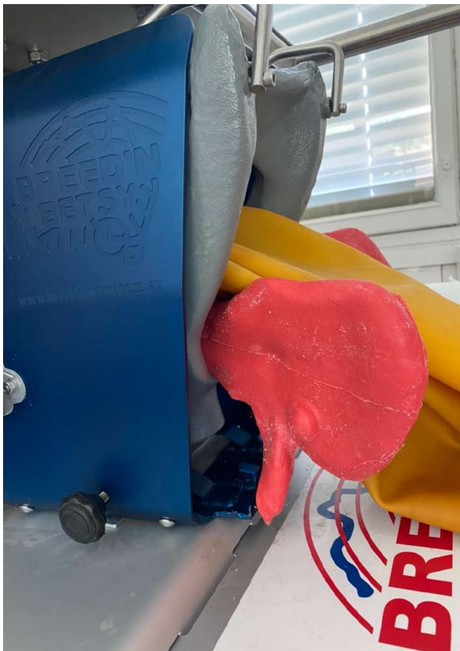
Figure 53 - Utérus rouge 33 Shore monté sur le modèle Breed'n Betsy®. L'utérus est fixé à l'adaptateur auto-agrippant, lui-même fixé au bouton pression. Le rectum est représenté en jaune.
