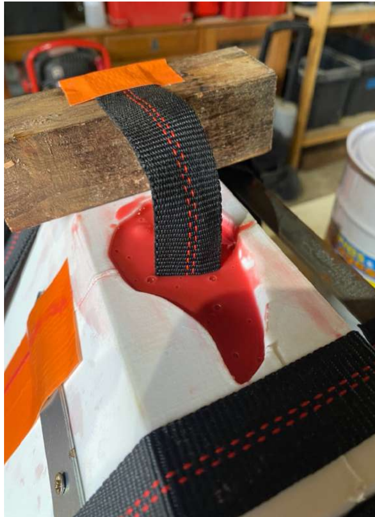
Figure 46 - Sangle insérée dans le silicone afin d'attacher l'utérus au support Breed'n Betsy®.
