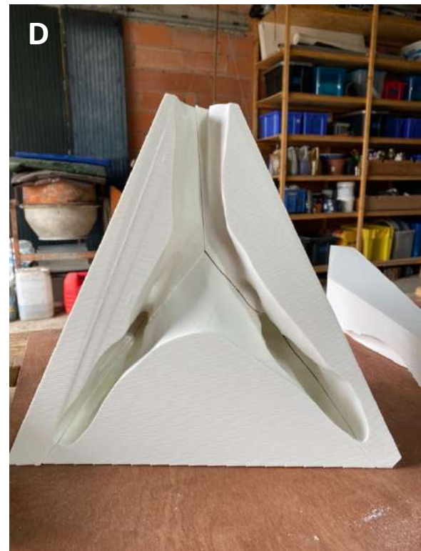
Figure 31 - Moule assemblé. A : vue dorsale ; B : vue caudale (depuis la sortie du vagin) ; C : vue ventrale sans les 2 pièces ventrales ; D : vue dorsale sans les 3 pièces dorsales.
