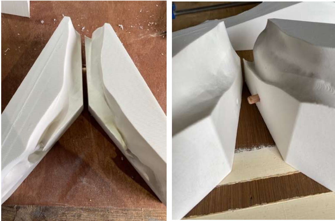
Figure 33 - Mise en place de chevilles en bois de diamètre 10 mm entre deux pièces du moule.
