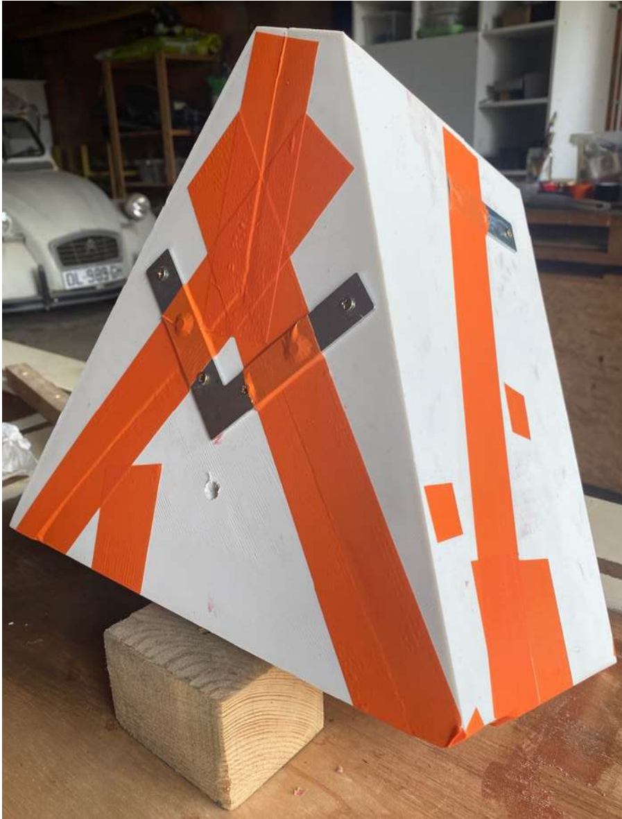
Figure 45 - Montage final pour le durcissement du silicone dans le moule.
