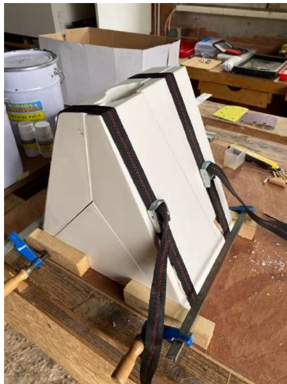
Figure 34 - Mise en place de sangles et de serre-joints pour fermer le moule et fixer les équerres
