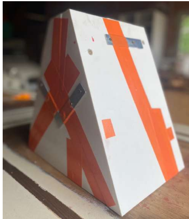
Figure 38 - Mise en place complète du moule pour le deuxième moulage.
