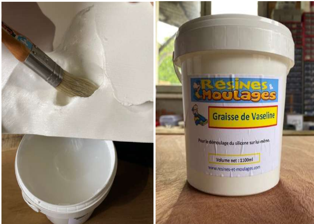
Figure 43 - Application de la graisse de vaseline au pinceau de manière homogène sur toutes les surfaces "utérines" des pièces.
