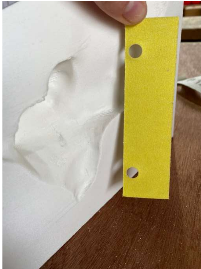
Figure 32 - Ponçage des surfaces internes des pièces du moule avec du papier abrasif
