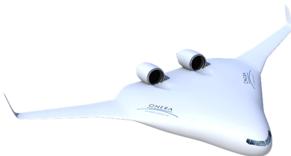
Figure 1 : Configuration d'aéronef en aile delta à l'étude à l'ONERA (© J. Gauvrit-Ledogar et M. Meheut).
