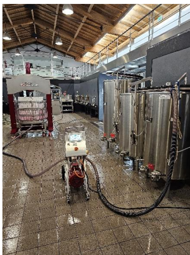
Figure 21 : Photo du pressurage à l'aide de la presse verticale puis transfert du vin dans les garde-vins (P1, P2 et P3)
