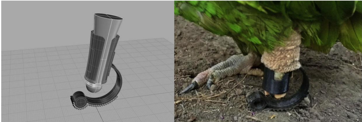
Figure 5. Modèle 3D (gauche) et prothèse imprimée (droite) chez un perroquet Amazone à lores rouges ( Amazona autumnalis ). (Galicia et al. 2018)
