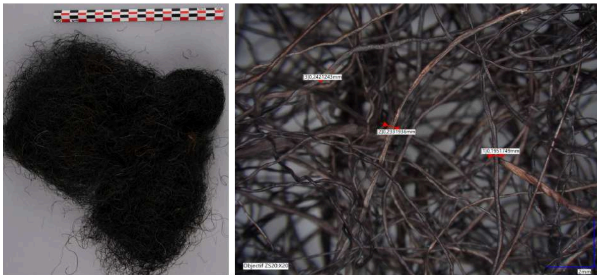
Figure 7 : Photographie et image microscope 3D (x200) de l'elancrin carboné. © Arnouil Julie
