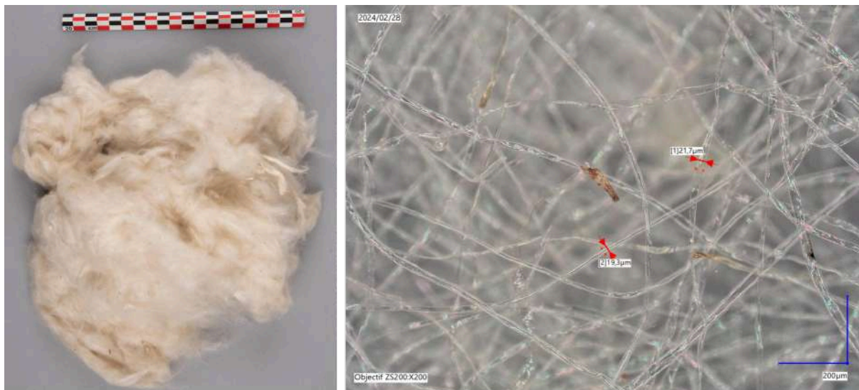
Figure 5 : Photographie et image microscope 3D (x200) de la fibre de Kapok. © Arnouil Julie
