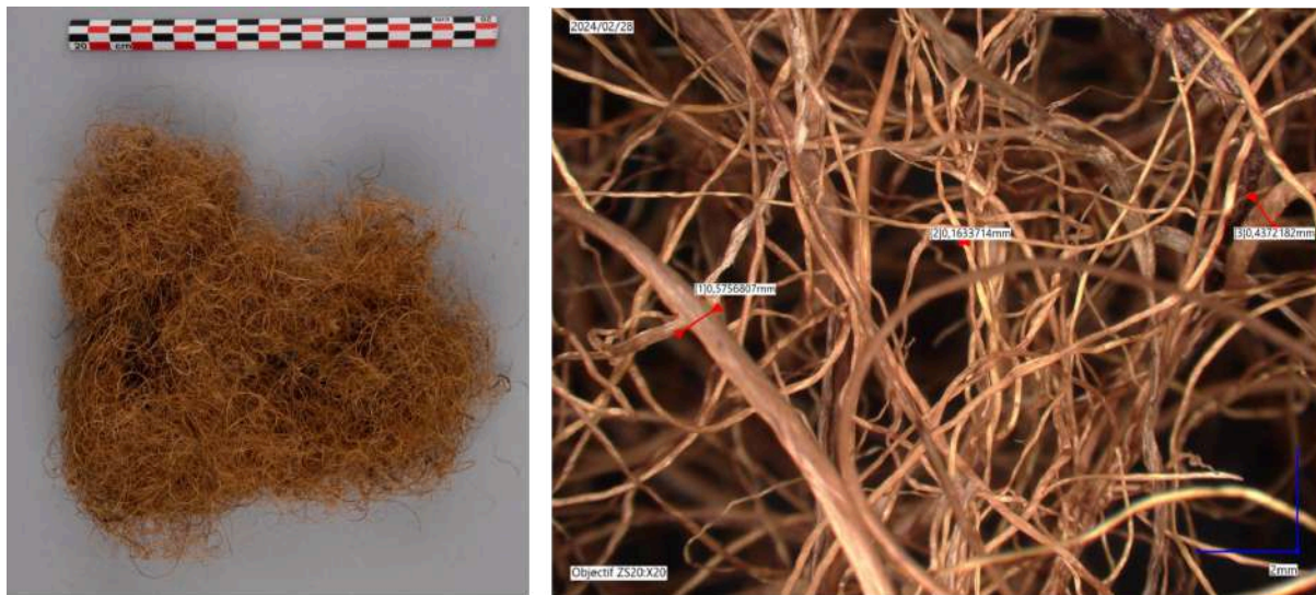
Figure 6 : Photographie et image microscope 3D (x200) de l'élanclin. © Arnouil Julie
