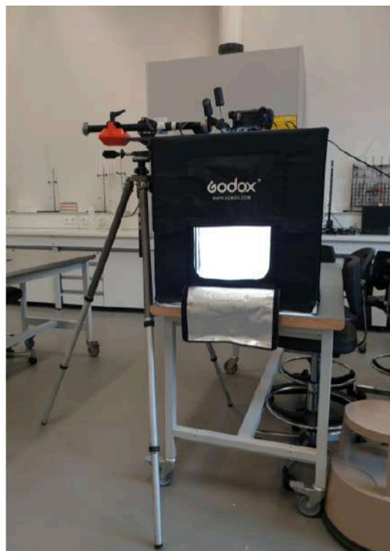
Figure 22 : Mise en place des prises de vue pour les tests d'usure et de reprise de forme. © Arnoull Julie
