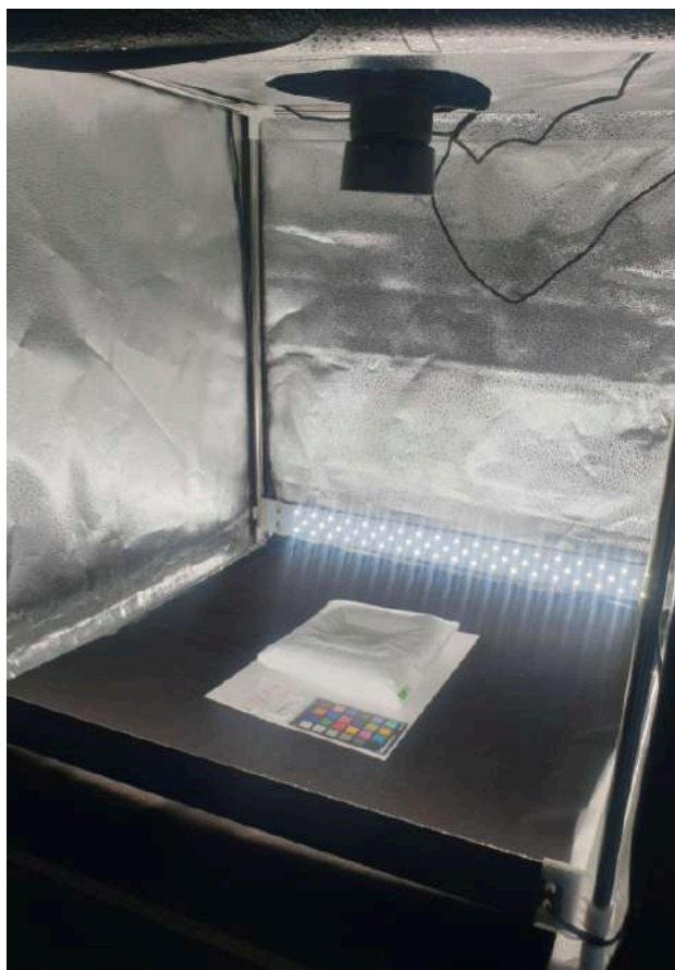
Figure 22 : Mise en place des prises de vue pour les tests d'usure et de reprise de forme. © Arnoull Julie
