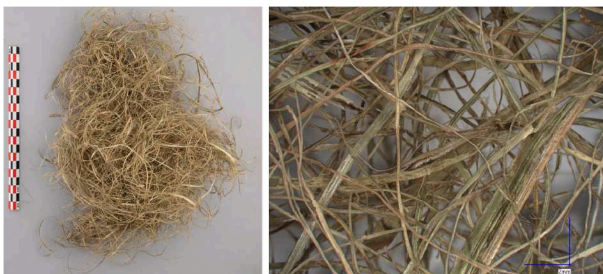
Figure 9 : Photographie et image microscope 3D (x200) du Crin Végétal. © Arnouil Julie
