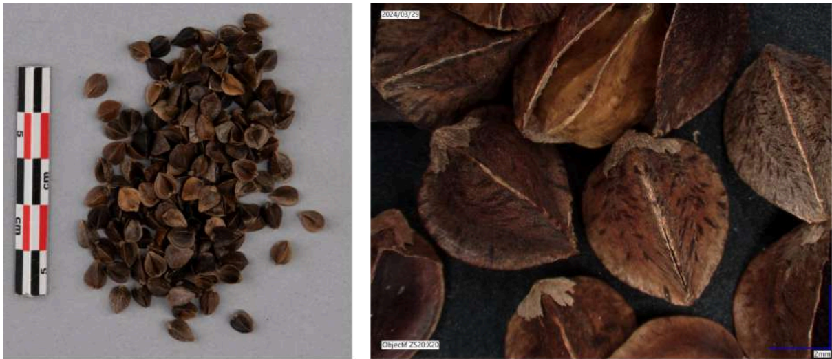
Figure 11 : Photographie et image microscope 3D (x200) des balles de sarrasin. © Arnouil Julie
