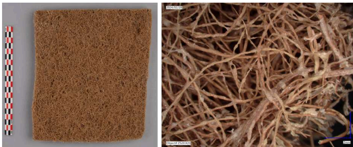
Figure 8 : Photographie et image microscope 3D (x200) de l'élanocrin latex. © Arnouil Julie
