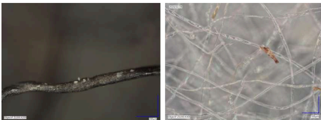
Figure 25 : Images au microscope 3D de l'elancrin carbone (x200) et du kapok (x300).
