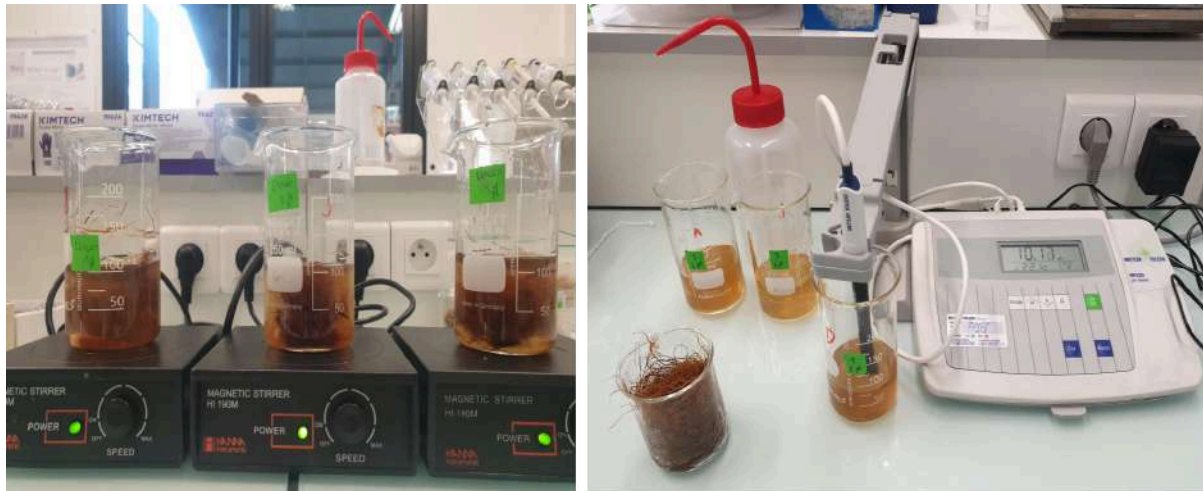
Figure 19 : Prise de vue des échantillons d'Elancrin lors des mesures de pH par macro-extraction © Arnouil Julie
