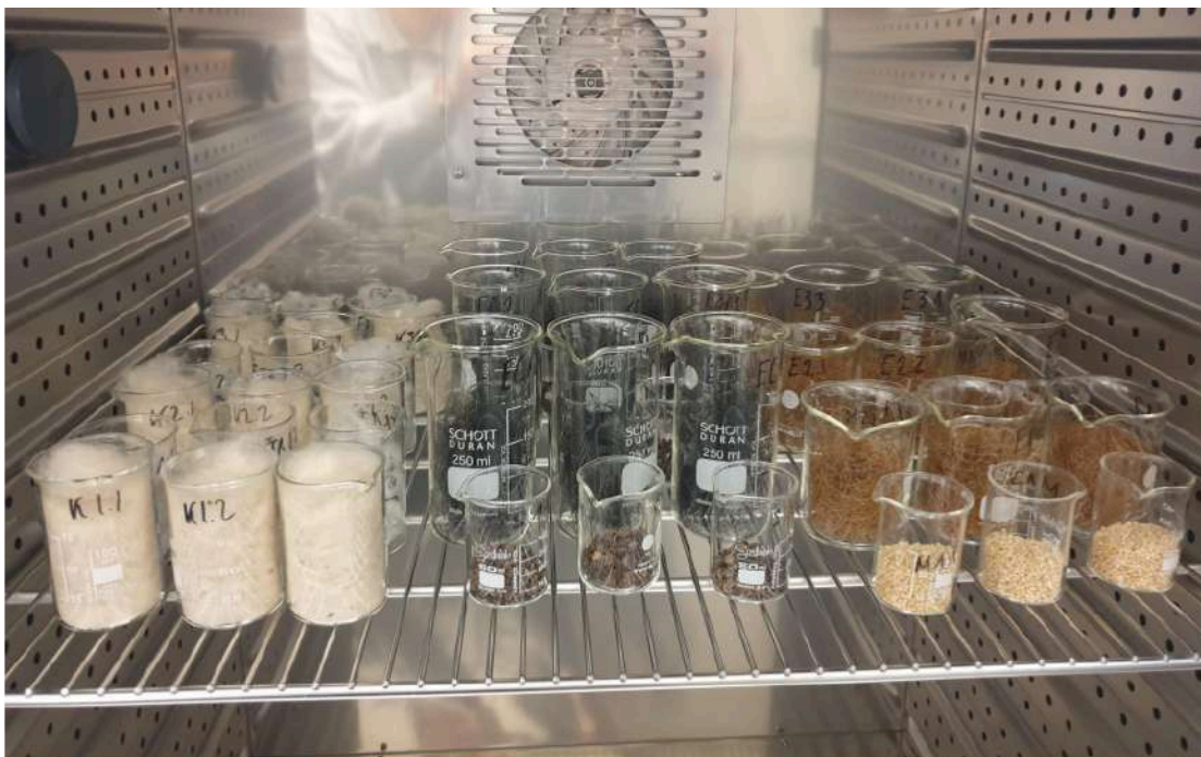
Figure 21 : Mise en place des échantillons dans l'enceinte de vieillissement.
