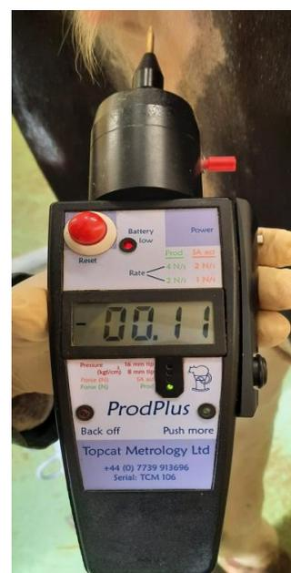
Figure 13: Algomètre de pression (Topcat® ProD-Plus Metrology) utilisé pour la réalisation des tests (collection personnelle)
