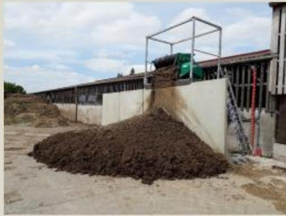
Photo 4 : Extraction de la fraction solide par un séparateur de phase pour des logettes creuses
