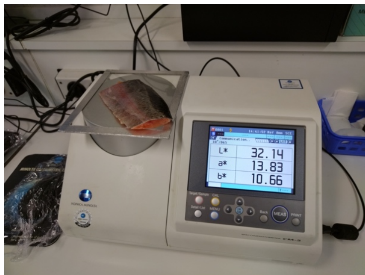
Figure 15 : mesure colorimétrique d'un filet de truite à l'aide d'un spectrophotomètre
