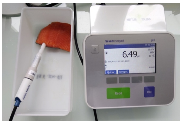
Figure 18 : mesure de pH sur un filet de truite
