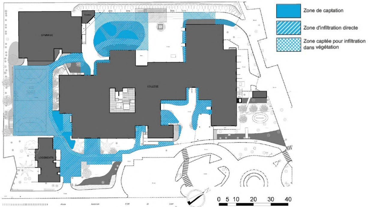
Figure 29 : Plan des zones d'infiltration des EP du collège Le Bassenon (Toposcope)
