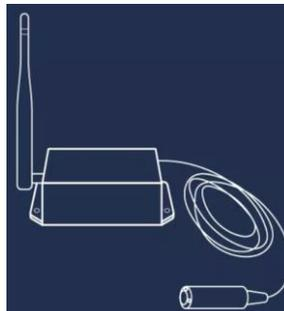
Figure 2 : Piézomètre [Source : Socotec Monitoring]
