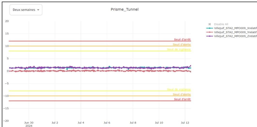
Figure 4 : Graphe de déplacements suivant les directions X, Y et Z et présence des seuils de sécurité (en rouge) sur Datatys [Source : Datatys]
