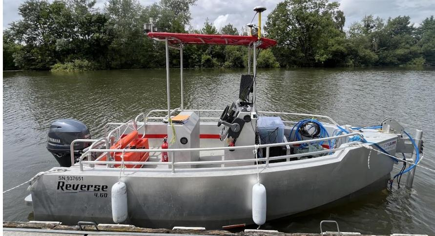
Figure 17 : La vedette bathymétrique Léon Foucault équipée des instruments de mesure (Photo personnelle)
