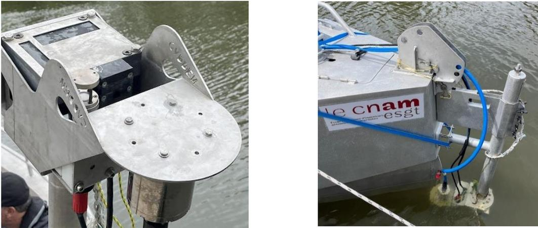
Figure 5 : Capteurs positionnés à l'avant du bateau sur une perche (Photos personnelles)
