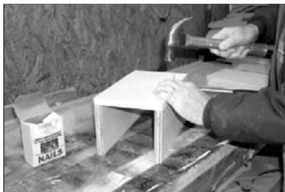
Etape 3: Clouer l'arrière à l'assemblage réalisé à l'étape 2
