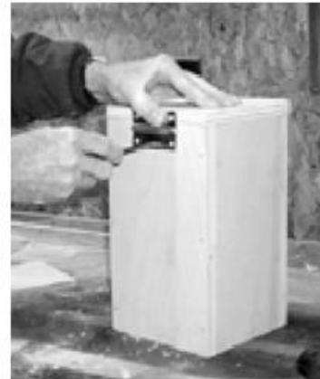
**Etape 6:** Percer un trou de 5 cm de diamètre à l'aide de la scie à trou. Le trou doit être centré et se trouver à environ 6.5 cm du haut
