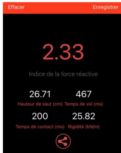
Figure 3 : affichage des données récoltées sur le Drop Jump avec MyJump 2
