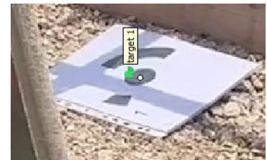
Figure 8 - Cible circulaire 12 bits pointé automatiquement dans Metashape. Source : Syslor.
