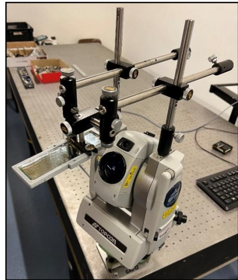
Figure 5 : Montage mécanique supportant le miroir fixé sur le Topcon MS1AXII (Photo personnelle)
