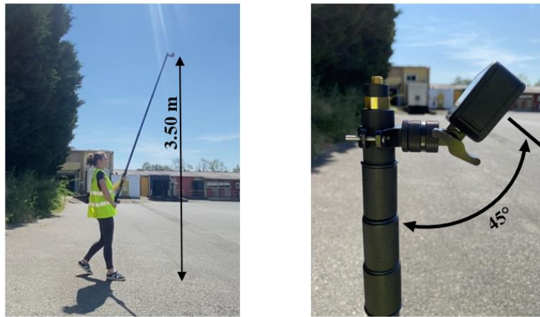
Figure 5 - Images de la position de la caméra nécessaire à un relevé de photogrammétrie terrestre.
