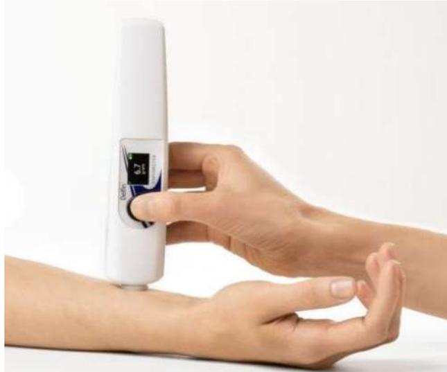
Figure 11 : Exemple d'utilisation de l'appareil Vapometer®.
