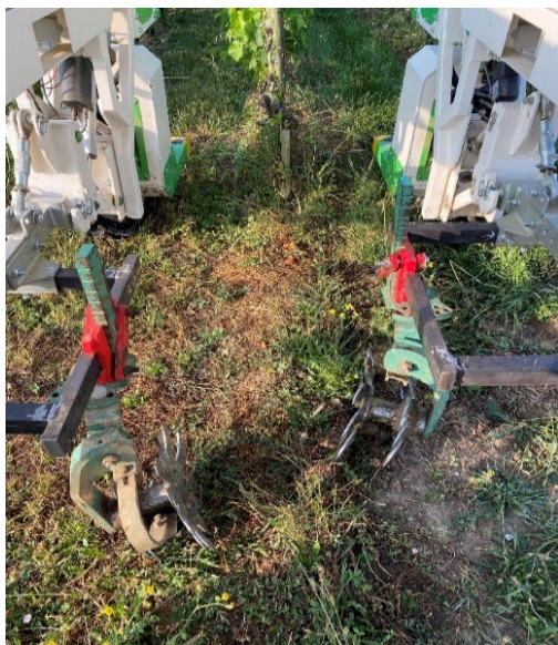
Image 11 : Installation de disques émotteurs sur le TED
