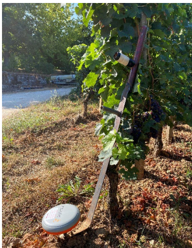
Image 7 : Béquille créée pour la prise de données cartographiques
