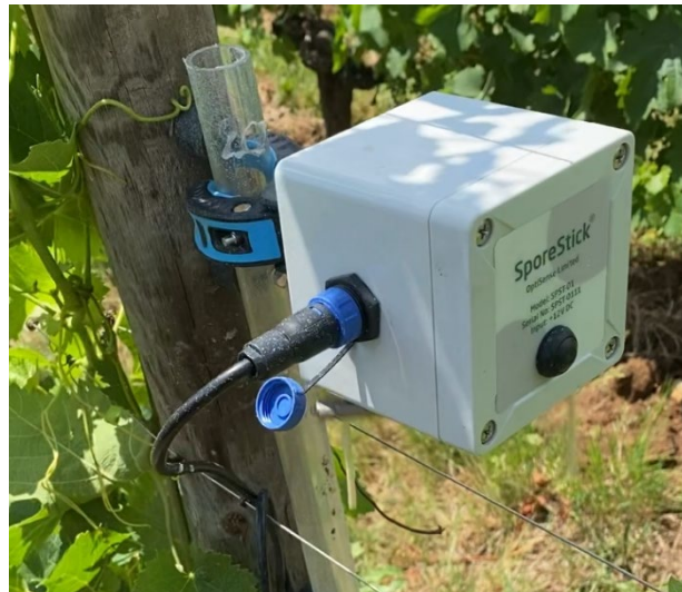
Image 14 : Capteur actif du Projet VISA - Château Fombrauge
