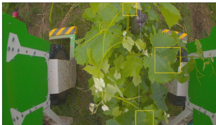
Image 15 : Photo accessible sur Chouette View pour le contrôle des tâches détectées sur le feuillage
