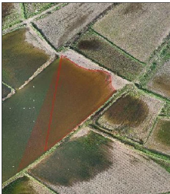
*Figure 41 : Exemple de digitalisation d'une inondation par remontée de nappe phréatique (Charpentier, 2024)*
