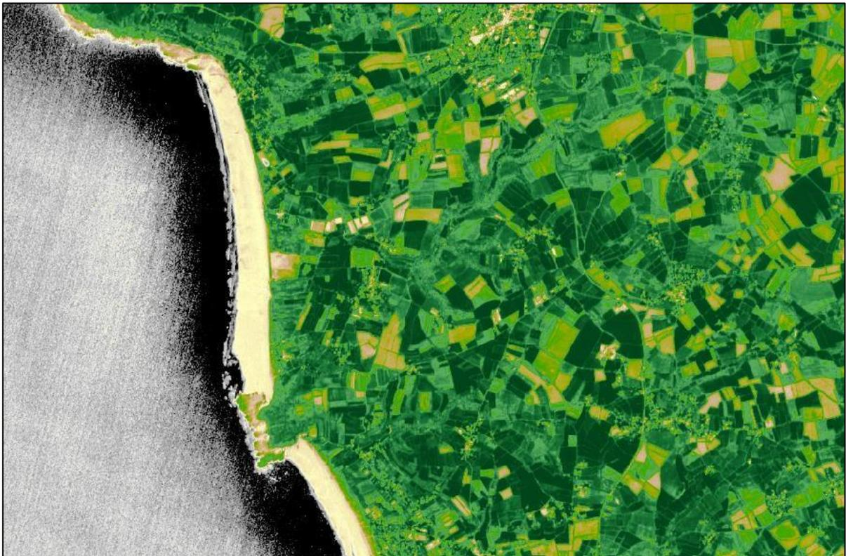
Figure 19 : Indice NDVI sur l’image Sentinel-2 du 15 Février 2021. (Charpentier, 2024)
