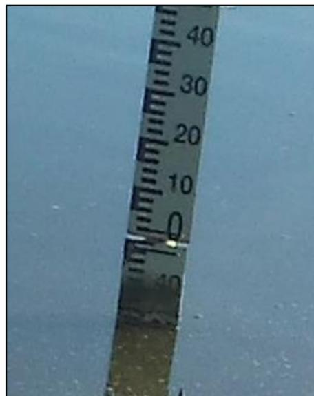
Figure 114 : Exemple de deux échelles limnimétriques assemblées (Charpentier, 2024)
