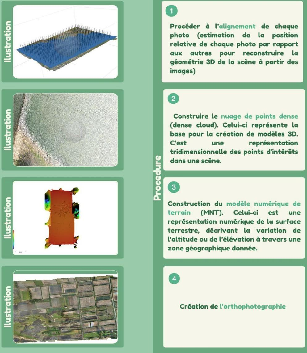
Figure 37 : Construire une orthophotographie avec Agisoft métashape (Charpentier, 2024)
