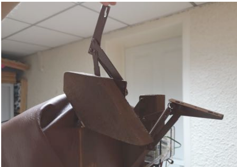
Figure 30 : Charnières fixées à la structure en bois, permettant à la partie droite de la tête de se soulever
