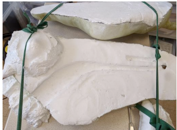
Figure 40 : Création des méats nasaux et des emplacements pour les câbles par ponçage de précision de la mousse expansive
