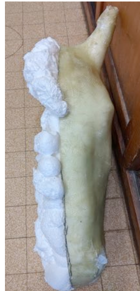
Figure 39 : Remplissage de la tête en résine par de la mousse expansive
