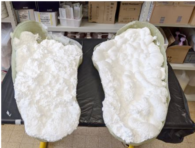
Figure 39 : Remplissage de la tête en résine par de la mousse expansive
