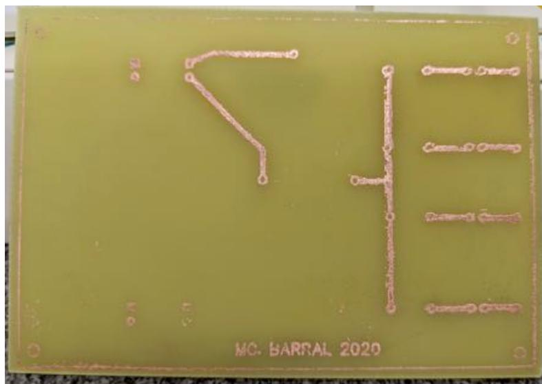
Figure 44 et 45 : Typon du circuit imprimé réalisé avec le logiciel gratuit EDA échelle 1/1, et circuit une fois réalisé, avant perçage et ajout des composants
