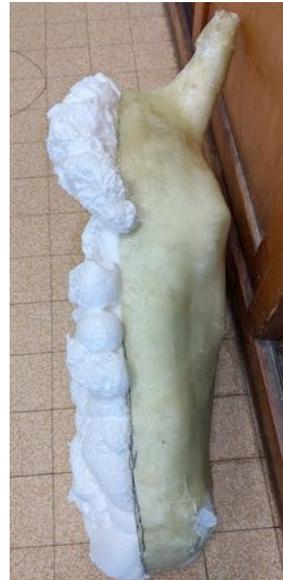
**Figure 39 : Remplissage de la tête en résine par de la mousse expansive**
