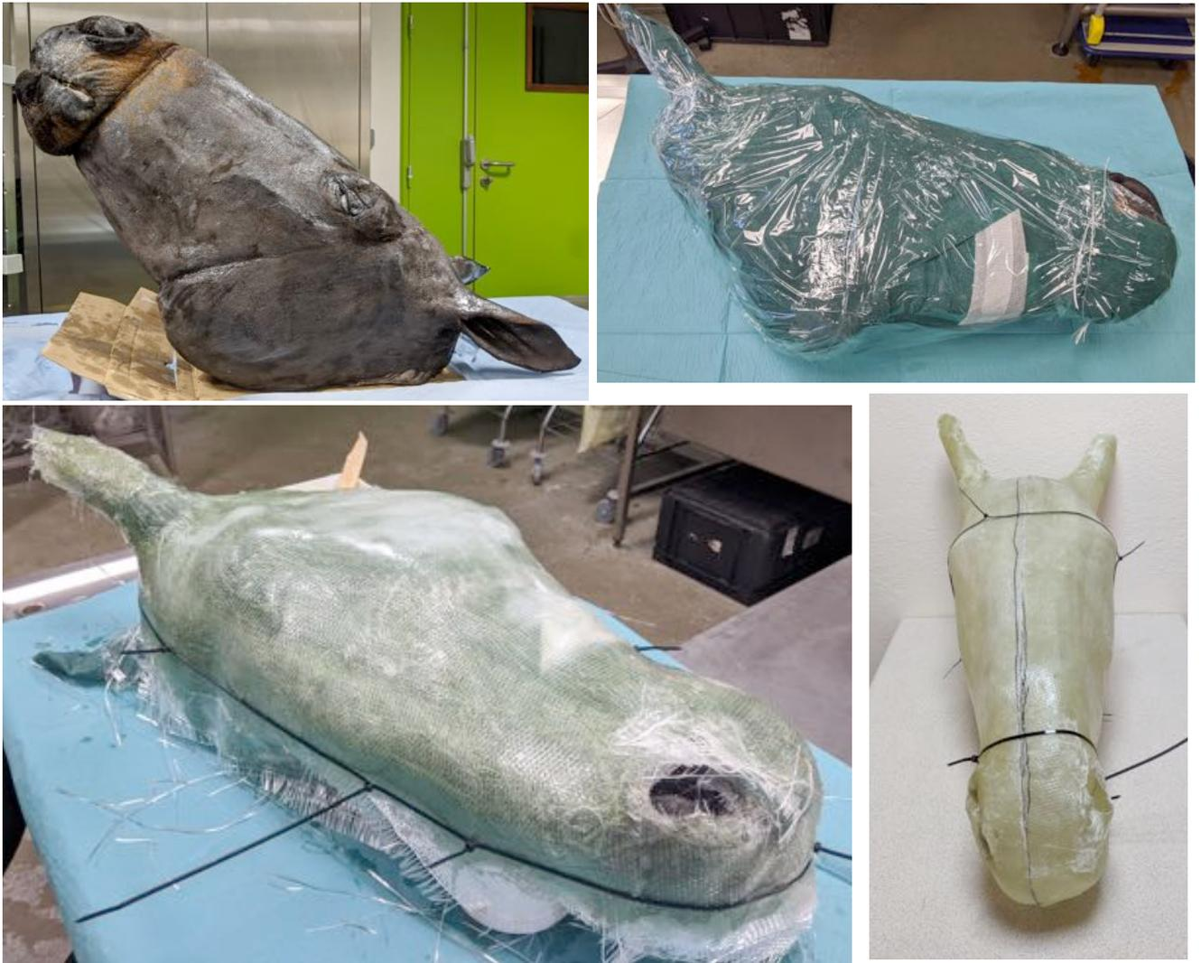
**Figure 26 : Préparation de la tête et moulage résine polyester et fibre de verre [MC Barral, EnvA]**
