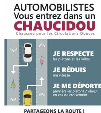
Figure 15 - Fonctionnement de la chaussée pour circulations douces (Morales 2021)
