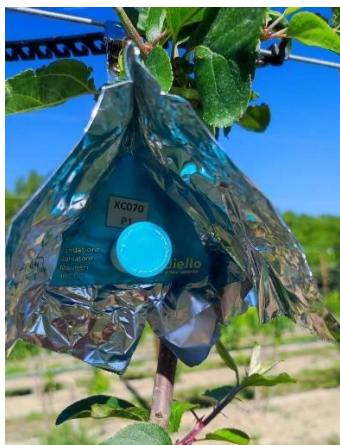
Figure 25. Dispositif de prélèvement des COV avec Radiello® accroché sur une placette (Victorine Kienlen)
