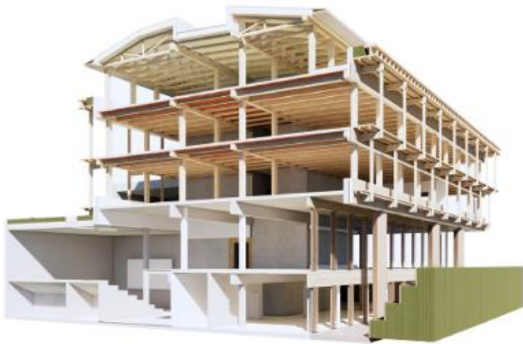
Abbildung 22 : Fotorealistische Ansicht der Holz-Beton-Mischstruktur (Atelier 2/3/4/)
